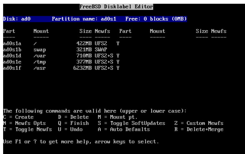
Зураг 2-20. Sysinstall-н Disklabel хэрэгслийн автомат тохируулалт
